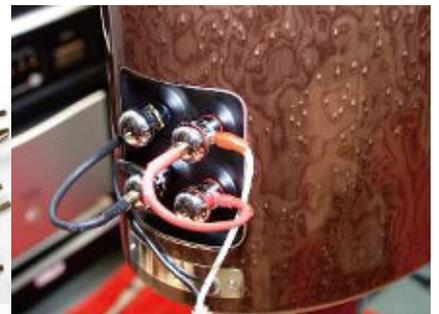
付属するジャンパー線は、「スぺードプラグ・バナナプラグ」と両端にそれぞれ異なるプラグ形状が採用されていますが、このようにすることでスピーカーケーブル端子が「スぺードプラグ」でも「バナナプラグ」でも接続が容易になります。両端の端子形状が異なると見かけがアンバランスになるためか、市販のジャンパー線ではほとんど見かけない端子処理（以前 AIRBOW のジャンパープラグに採用）ですが、外観やデザインにこだわる B&W が「あえて」そういう気配りをしてきたことはちょっとした驚きでした。
